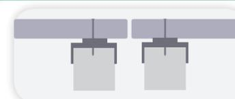
Afin de favoriser l'écoulement de l'eau, il est nécessaire de réaliser un double lambourrage en bout de lame dans le but de fixer chacune des lames sur une ossature différente.
