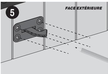
5 Le crochet doit être au centre de la fente pour assurer une bonne manœuvre.
