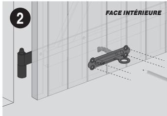
2 **Attention** : le crochet de l'arrêt à ressort doit être pointé vers le gond.
