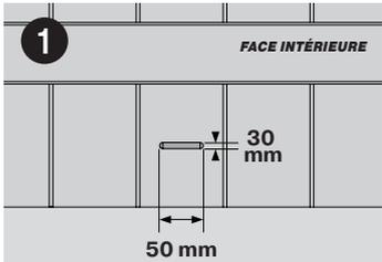
1 Percer une fente traversante 30x50 mm.
