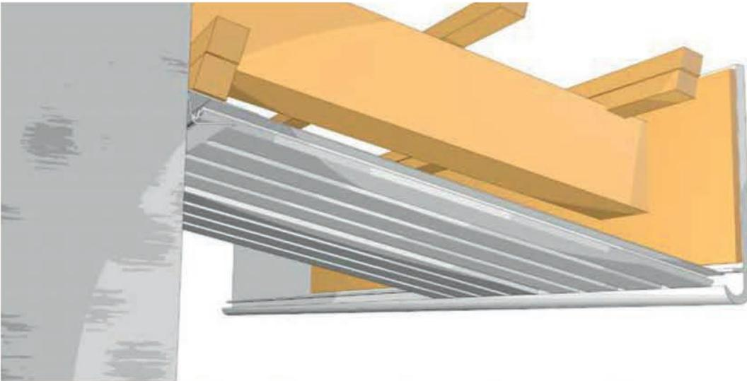
Les planches RIVECEL et F9 épaisseur 9mm se fixent en habillage d'un contre bandeau bois de qualité «Extérieur» d'une épaisseur de 16mm minimum. Chaque point de fixation comportera 2 pointes INOX ou vis INOX. Les planches épaisseur 9mm ne sont pas auto-porteuses, le dernier rang de tuiles doit reposer sur un double liteauage.
