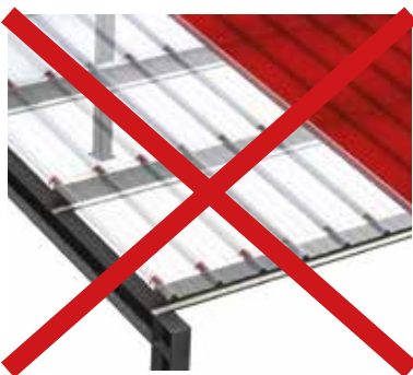
Interdit en rive
