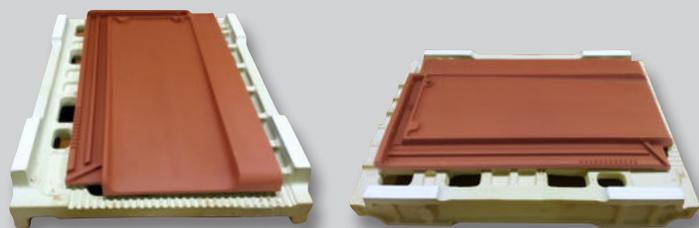
Support réfractaire unitaire en H permettant une cuisson à très haute température (klinker) garantissant ainsi une planéité parfaite.
