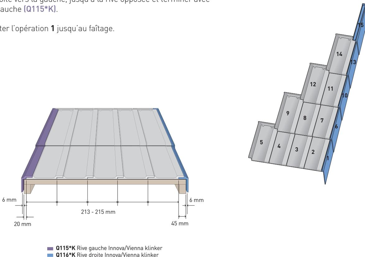
**NOTE :** il est recommandé de tracer une ligne de contrôle toutes les 3 ou 5 rangées maximum.
