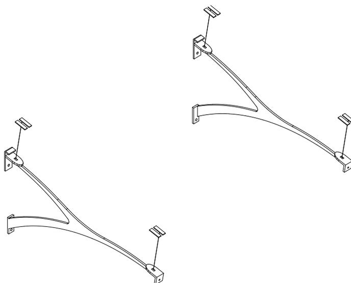
**Etape 2 : Ajuster le joint au support de chaque console à l'aide d'un paire de ciseaux ou d'un cutter.**
