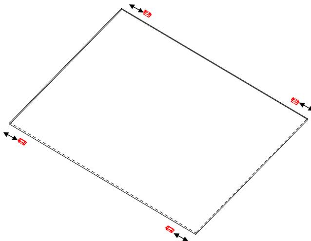
**Etape 4 : Positionner le vitrage sur les consoles en insérant le vitrage et le joint coté mur en premier.**
