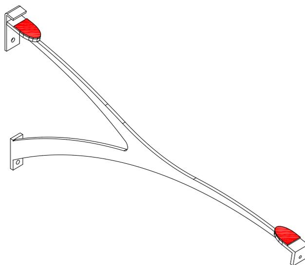
**Etape 3 : Positionner les joints en forme de U sur le vitrage à 125 mm des bords**
