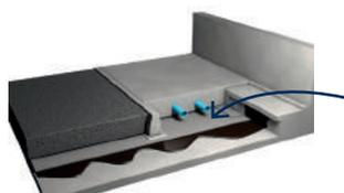
Feuille d'étanchéité soudable en adhérence, placée directement sous les enrobés. Les paillettes d'ardoise colorées gris clair assurent la protection contre les rayons UV durant les phases de construction puis une excellente protection mécanique durant la mise en œuvre des enrobés.
