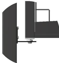
Il est nécessaire de régler l'espace entre les 2 vantaux à 26mm (Fig B) afin d'obtenir une fermeture optimale. Il suffit d'utiliser le réglage des pivots possible (Fig A et A') pour obtenir la cote de 25mm.
