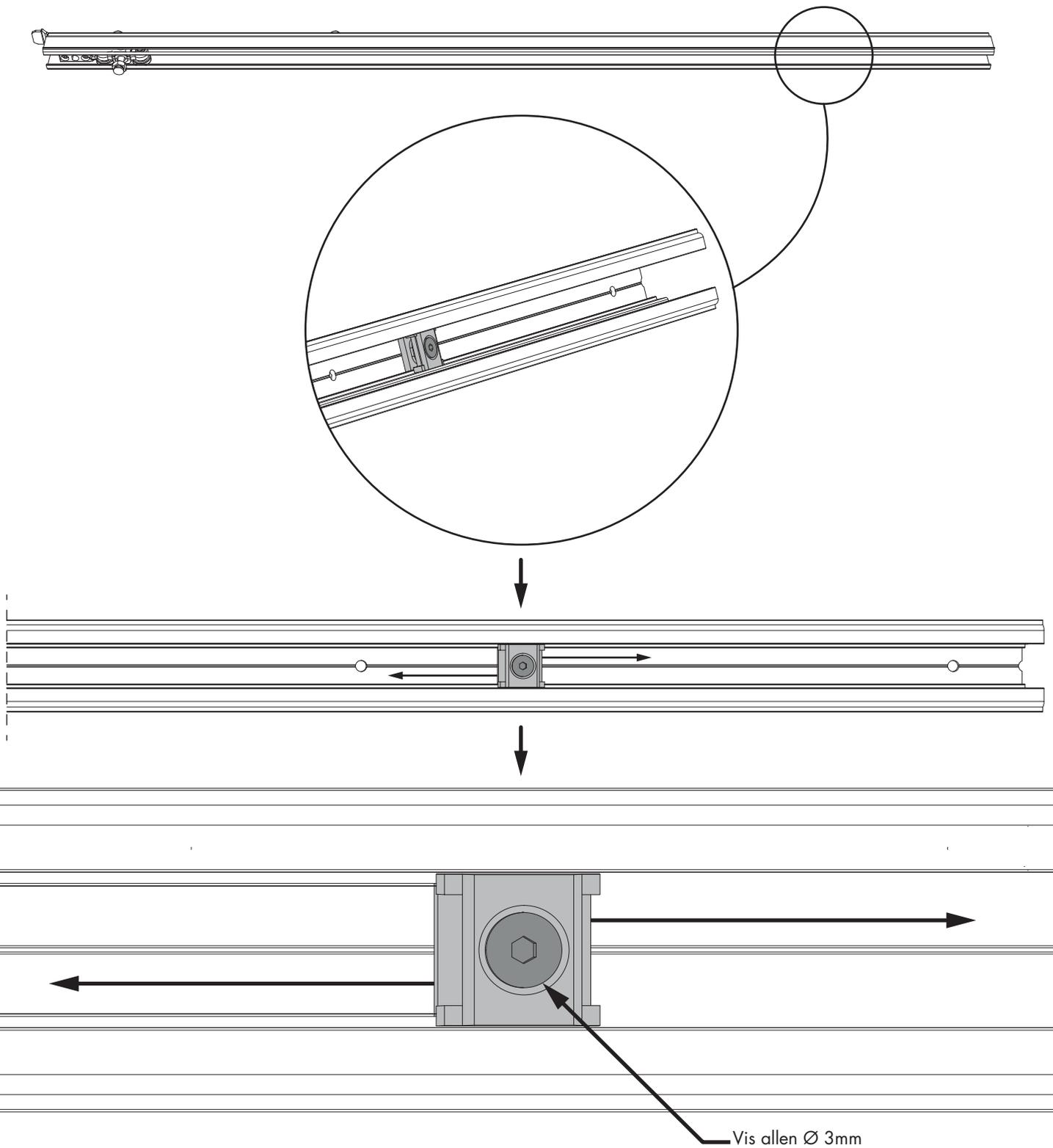
**1 - Désérer** la vis à l'aide d'une clef allen Ø 3mm
