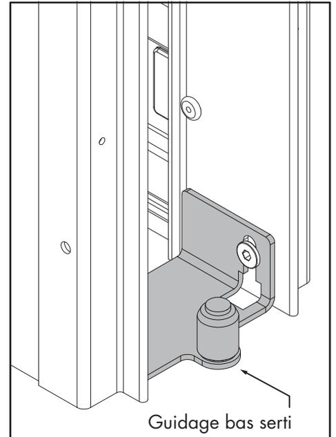
Si le montage est avec une porte structure aluminium, utiliser le guidage bas serti livré avec la porte.
