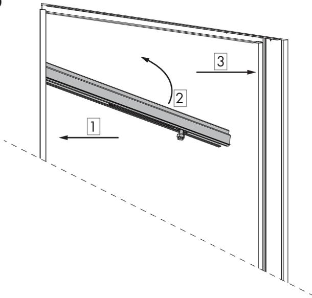
1 Faire glisser le rail vers le fond du caisson en prenant appui sur la traverse haute et dans son axe. Mettre le rail en butée dans le fond du caisson.
