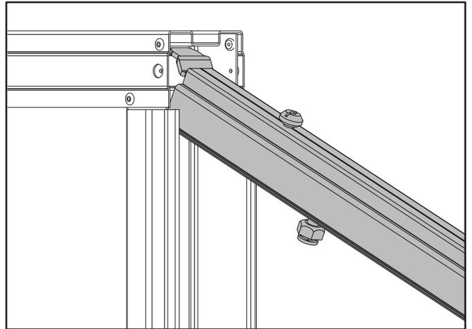
3 Aligner le perçage du rail avec le perçage de la traverse haute.
