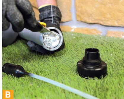
Couper le clips de sertissage à l'aide d'une pince coupante ou perforer le bout visible de la poche à l'aide d'un cutter.
