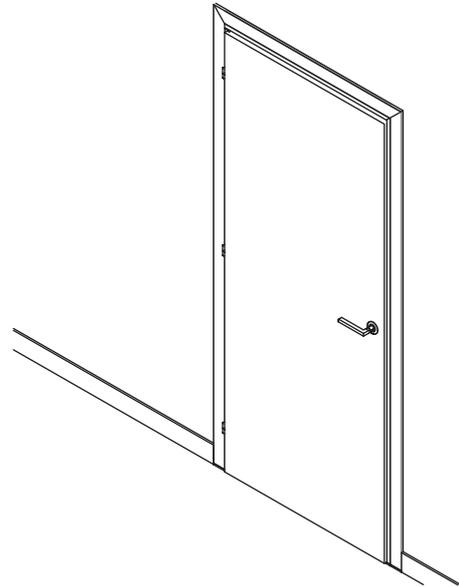
Le bloc-porte est prévu avec un espace de 12mm en partu base pour la ventilation.
