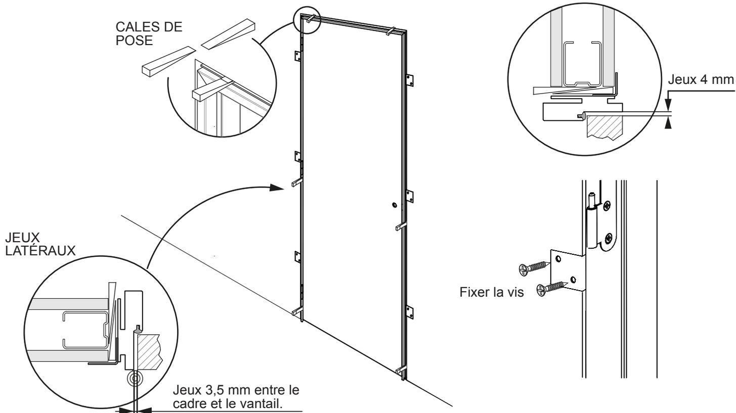
**10** Les profil sont livrés à longueur et avec l'usinage pour le vissage effectué.
