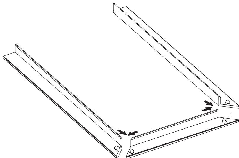
Introduire les vis excentriques dans les trous déjà usinés sur le dessus des chambranles et contre-chambranles et serrer avec le tournevis
