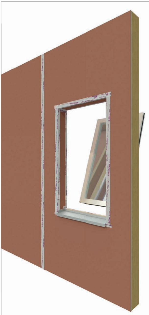
3 Mise en place de la menuiserie
