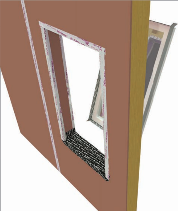
5 Mise en place de la menuiserie (préalablement pourvue de son calfeutrement – cf. 1)
