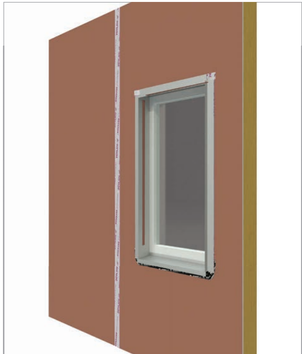
7 Mise en place du précadre métallique
