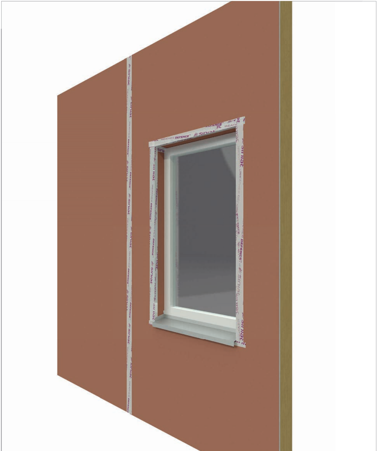
5 Vue finale après fixation de la bavette métallique sur rejingot
