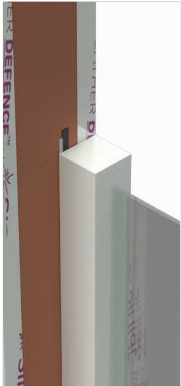
4 Calfeutrement conforme au DTU 36.5
