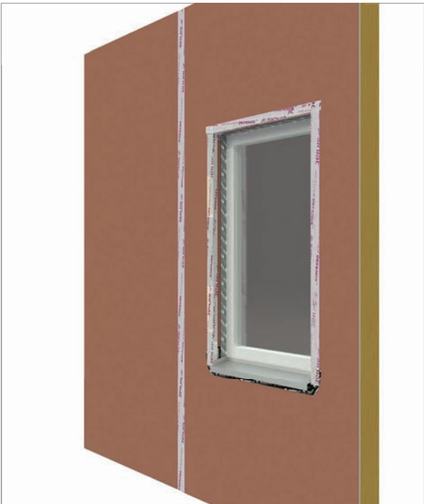
6 Mise en place de la bavette
