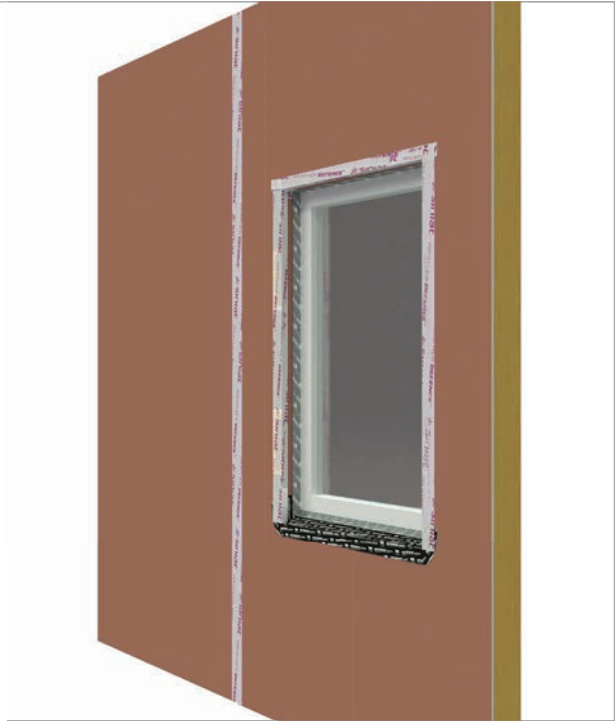
5 Mise en place de la menuiserie (préalablement pourvue de son calfeutrement – cf. 1)
