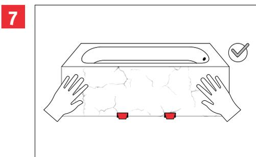
Faire un montage à blanc sur le tablier de baignoire existant afin de vérifier l'ajustement des pièces.
