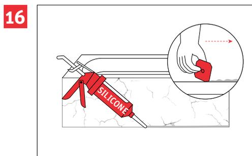
Faites un joint silicone au sol et sur les remontés du mur pour l'étanchéité.
