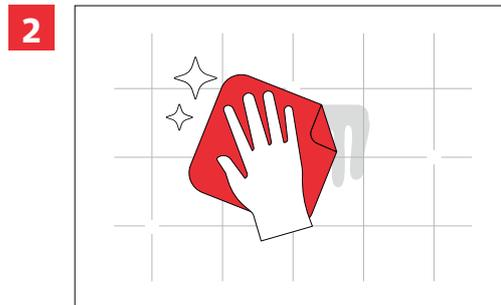
Préparation du support : les tabliers sous la baignoire doivent préalablement être installés avant la mise en place de Tablipanel. Le support doit être stable, uniforme, sain et sec. Appliquer un primaire sur les supports fortement absorbants (plaques de plâtre par exemple).
