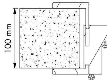
**C** Configuration avec option kit extension (cloison de 101mm à 120mm maxi).
