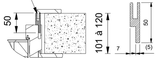
**D** Configuration avec option kit extension (cloison de 121mm à 295mm maxi)
