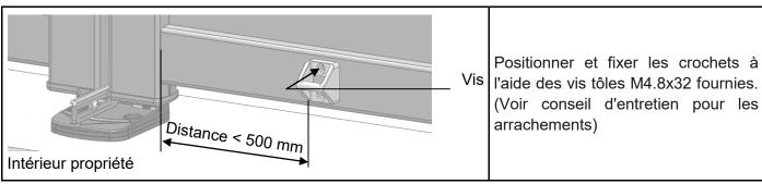
Après avoir fixé les crochets, ré-ouvrir le portail jusqu'à la position finale désirée tout en respectant la norme définie ci-dessus. Maintenir le portail dans sa position ouverte et déterminer les places des arrêts en fonction des emplacements des crochets.
