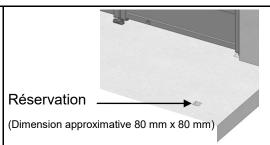
Ouvrir le portail et déterminer la hauteur de scellement de l'arrêt en fonction du crochet (conseil : maintenir l'arrêt au crochet à l'aide d'une ficelle ou autre pour avoir une position de scellement idéale).
