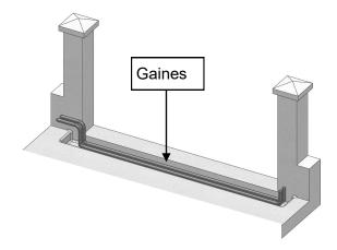
Pour des aspects pratiques et esthétiques, il est impératif de mettre en place des gaines dans la structure en béton permettant le passage des différents câbles liés aux automatismes. Tous les fils doivent impérativement être glissés dans des gaines (les fils électriques sont des fils souples « spécial extérieur »).
