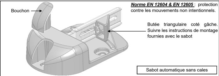
Positionner la butée d'arrêt automatique à l'axe des deux vantaux; la partie pleine du sabot se situe en butée de fermeture. Fixer le sabot avec ces cales au sol (fixations non fournies, à adapter suivant la nature du support).
