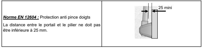
Une fois le portail assemblé ouvrir les vantaux au maximum (voir norme ci-dessus) afin de déterminer les positions des arrêts et des crochets. (Il est recommandé d'installer l'ensemble le plus éloigné possible des piliers, afin d'avoir une meilleure tenue des vantaux en position ouverte).
