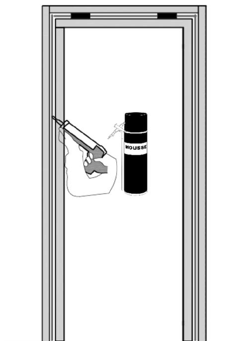
Respecter le temps de prise indiqué par le fabricant de la mousse polyuréthane, puis retirer les calages.
