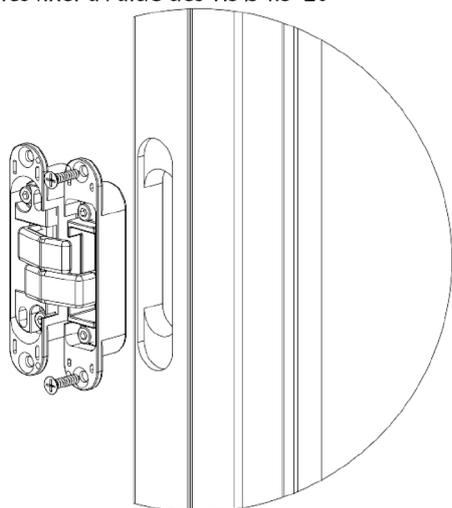
2 - Equiper la porte de la serrure en respectant le sens d'ouverture. Fixer la porte aux charnières à l'aide des vis  $\varnothing 4.5 \times 60$ .
