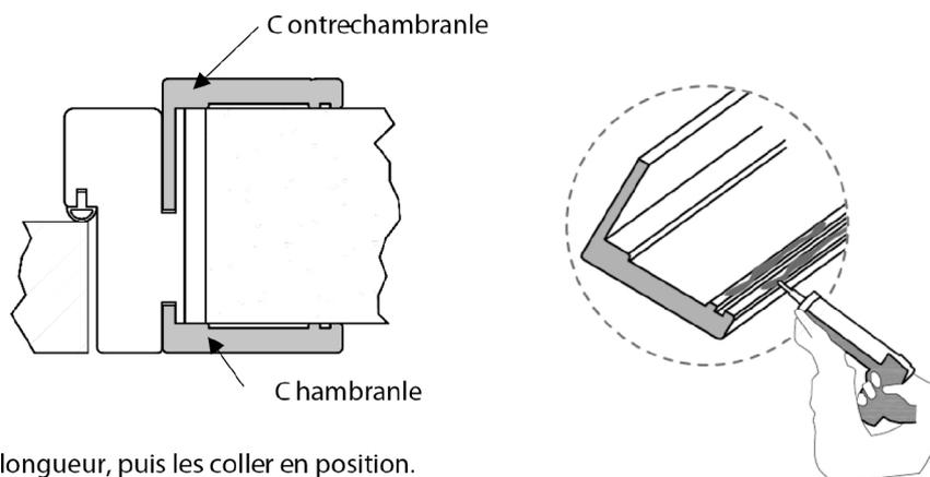
Vérifier les dimensions des traverses mettrea longueur, puis les coller en position.
