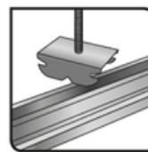
1. Visser le cavalier pivot sur la tige filetée et le maintenir par un écrou
