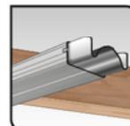
1. Insérer le raccord de fourrure dans l'extrémité de la fourrure.
