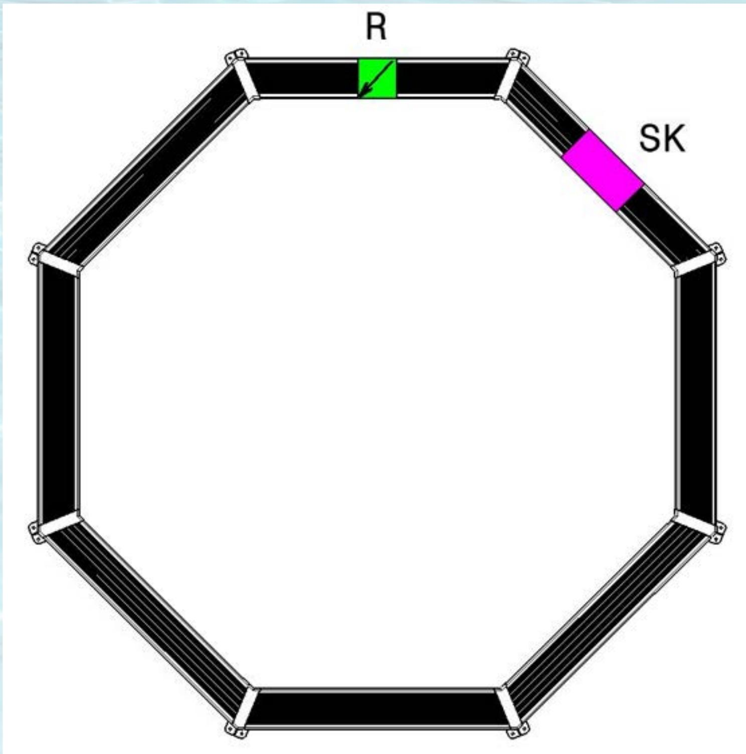
Plan d'installation du skimmer (SK) et de la buse de refoulement (R) pour le modèle TATIHOU
