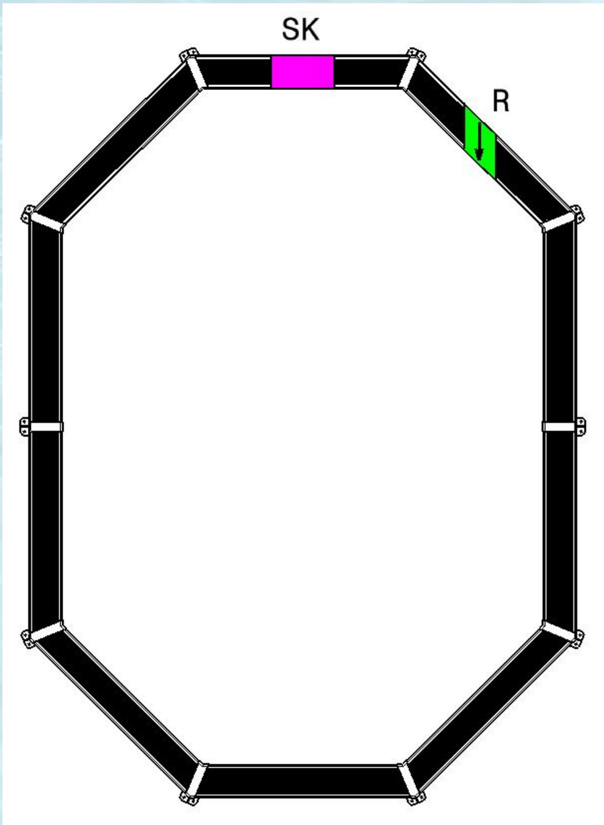
Plan d'installation du skimmer (SK) et de la buse de refoulement (R) pour le modèle GRANVILLE
