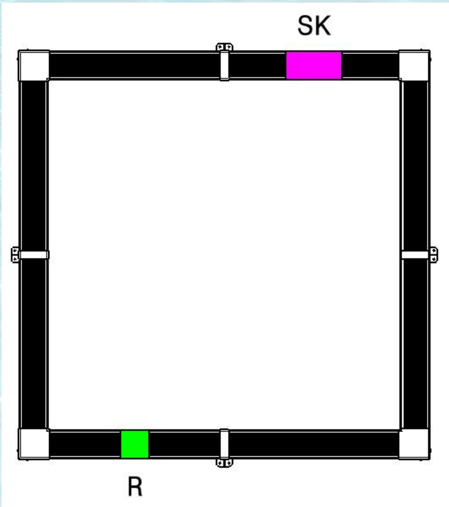
Plan d'installation du skimmer (SK) et de la buse de refoulement (R) pour le modèle MILLY
