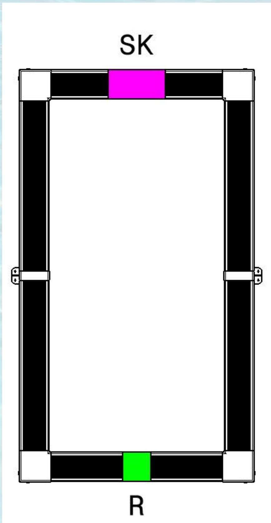
Plan d'installation du skimmer (SK) et de la buse de refoulement (R) pour le modèle BRÉHAL
