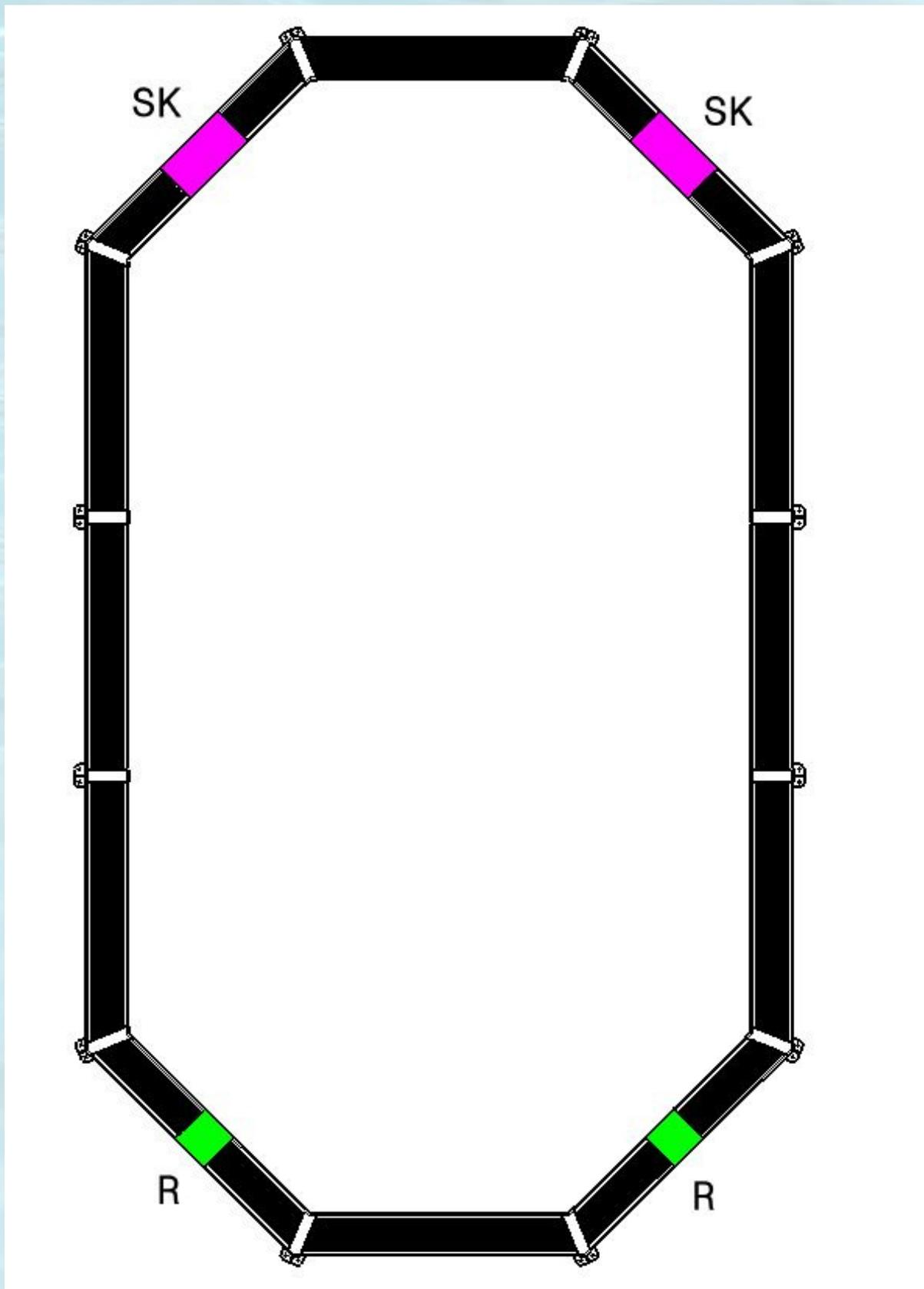
Plan d'installation des skimmers (SK) et des buses de refoulement (R) pour le modèle AGON
