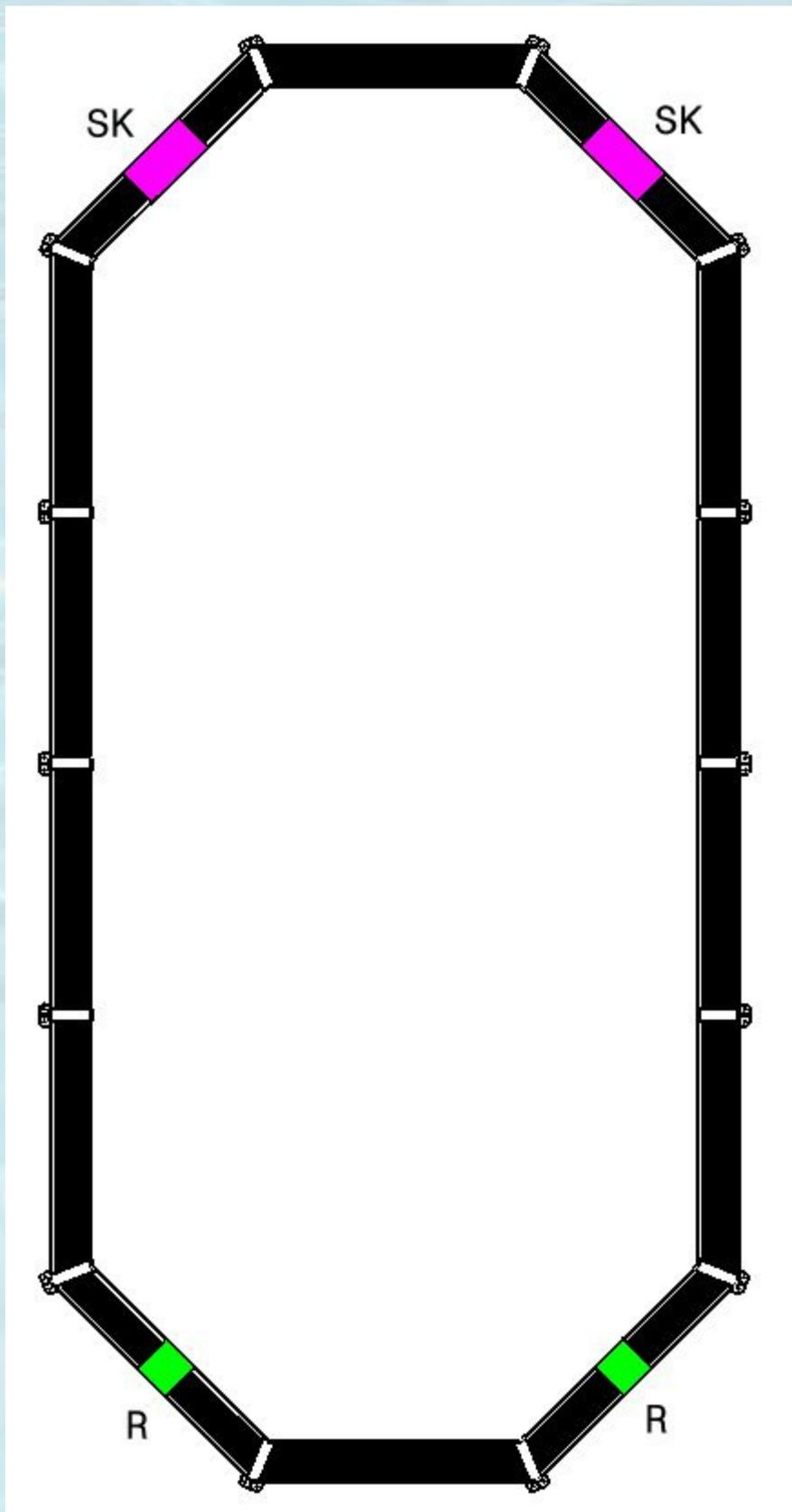
Plan d'installation des skimmers (SK) et des buses de refoulement (R) pour le modèle ROMAGNY
