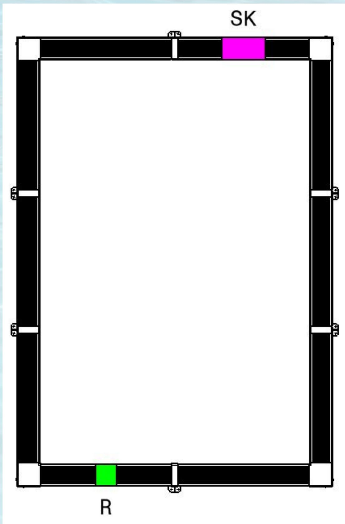
Plan d'installation du skimmer [SK] et de la buse de refoulement [R] pour le modèle PORTBAIL
