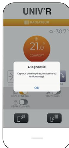
**La sonde de température est défectueuse** et doit être reconnectée ou remplacée.
